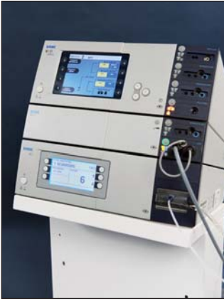
Abb. 7a: Wasserstrahldissektor „Erbejet 2“ bestehend aus einer mobilen Einheit mit Generator, Absaugeinheit sowie mechanischer Pumpeinheit und angeschlossenem Handstück.
